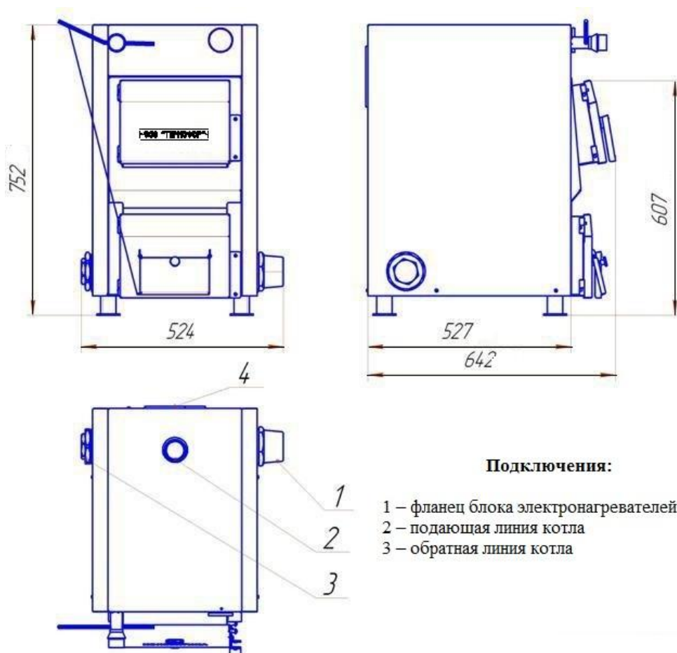
Рисунок 3. Размеры и подключения
